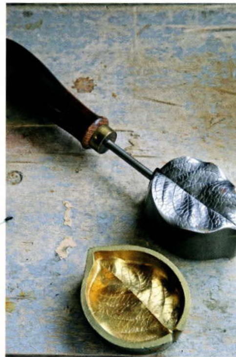
Koperen mal waarmee reliëf wordt aangebracht.
