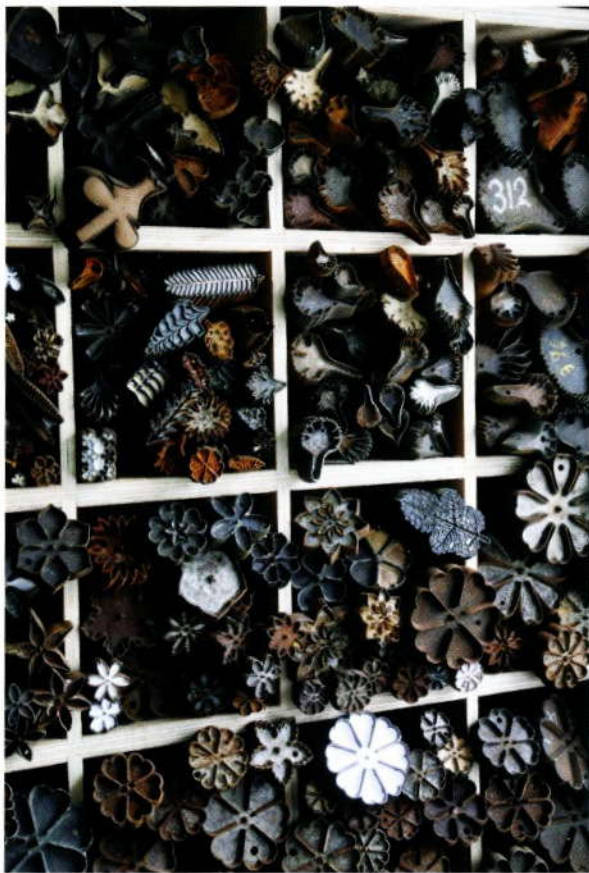
Kast vol mallen voor de machine waarmee de blad- of bloemvorm uit stof wordt gedrukt.
